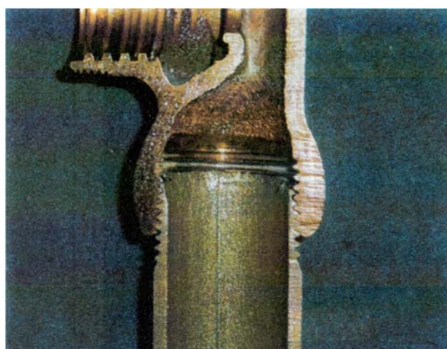
左の管を酸で洗って錆瘤を除去した状態 管の肉厚が少し薄くなってネジの先端が一部消失している
